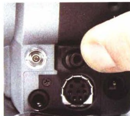
È molto importante controllare il tipo di connettori presenti sulla fotocamera: se questa dispone di una connessione seriale (nell'immagine) e si intende usarla con un computer dotato delle sole prese USB, non sarà possibile trasferire direttamente le foto dalla macchina al computer.
